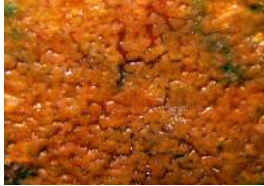
Resim 120: Seger Deneme Numarası (2) 750°C'de Çinko Kromatlı Sır Detayı
