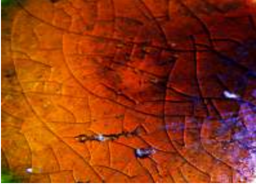
Resim 96: Seger Deneme Numarası (1) 750°C'de Demir Kromatlı Sır Detayı
