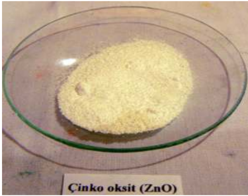
Resim 37: Krakle sırlarda krakle oluşumunu sağlamak için kullanılan en bilindik oksittir.
