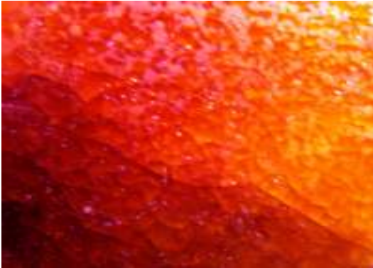
Resim 98: Seger Deneme Numarası (2) 750°C'de Demir Kromatlı Sır Detayı
