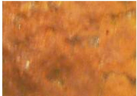
Resim 186: Seger Deneme Numarası (2) 750°C'de Potasyum Bikromatlı Sır Detayı
