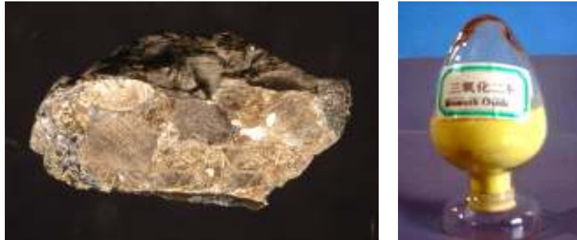
Resim 15: Kayaç halde bulunan Bizmut metali ve cam endüstrisinde sıkça kullanılan Bizmut Trioksit
