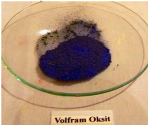
Resim 73: Volfram Oksit sır bünyesinde sıkça kristal oluşturma eğilimi gösteren ve elde edilmesi zor olan nadir oksitlerdendir
