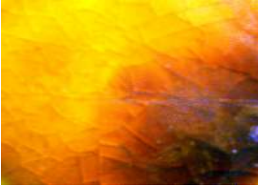
Resim 97: Seger Deneme Numarası (1) 1020°C'de Demir Kromatlı Sır Detayı
