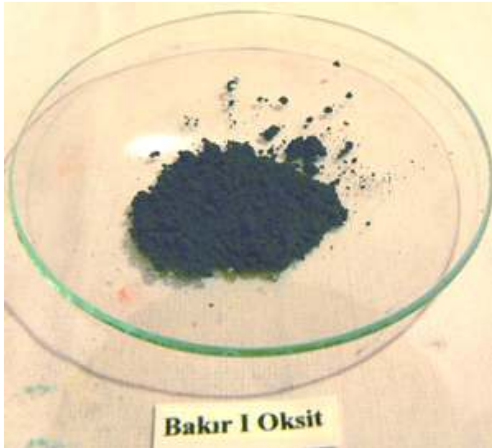
Resim 70: Bakır oksit seramik teknolojisinde sır bünyede kullanılan en temel renklendirici oksitlerden biridir. Düşük derece sırlarda türkuaz, yeşil, mavi ve siyah tonları almak mümkündür.
