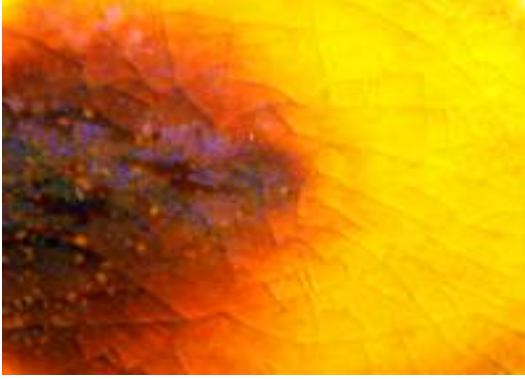
Resim 100: Seger Deneme Numarası (3) 750°C'de Demir Kromatlı Sır Detayı
