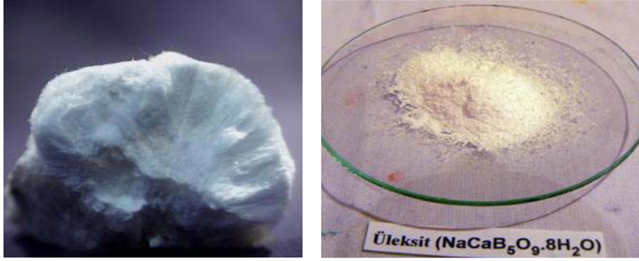
Resim 23: Neredeyse tüm düşük derece artistik ve endüstriyel sırlarda geniş bir kullanıma sahip olan bir bor bileşiğidir. Elde edilmesi son derece kolay ve ucuzdur.
