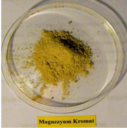
Resim 172: Kristal suyunda 100^\circ C de kalsine edilerek kurutulmuş magnezyum kromat
