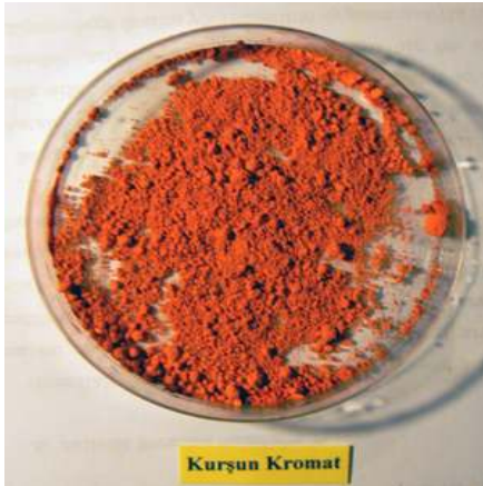
Resim 150: Kurşun kromatın kuru haldeki görünümü
