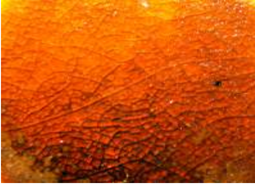
Resim 101: Seger Deneme Numarası (3) 1020°C'de Demir Kromatlı Sır Detayı
