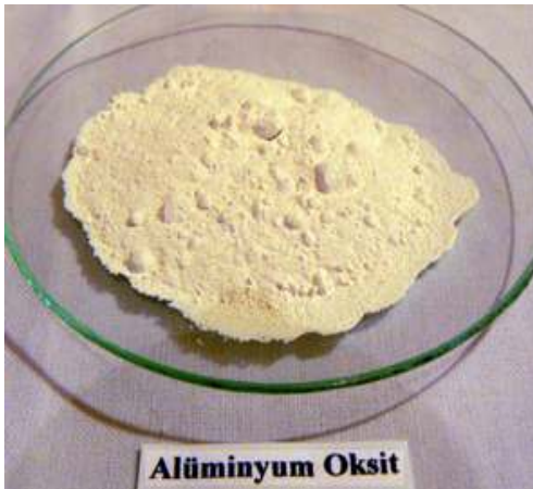
Resim 66: Alüminyum oksit çamur ve sır bünyede derece yükseltici etkisi vardır. Alüminyum oksitle zintelenmiş tuğlalar bugün fırın tuğlaları ve konstrüksiyonları olarak kullanılmaktadırlar.
