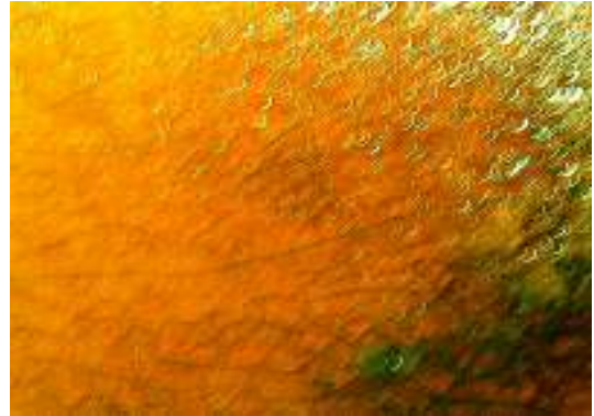
Resim 180: Seger Deneme Numarası (4) 1020°C'de Magnezyum Kromatlı Sır Detayı
