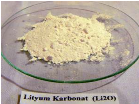
Resim 56: İlaç sanayinde sıkça kullanılan Lityum karbonat seramik teknolojisinde mükemmel bir eriticidir.
