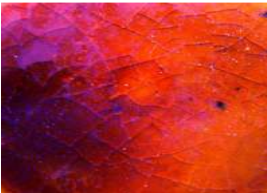
Resim 99: Seger Deneme Numarası (2) 1020°C'de Demir Kromatlı Sır Detayı
