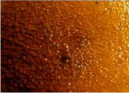
Resim 105: Seger Deneme Numarası (5) 1020°C'de Demir Kromatlı Sır Detayı
