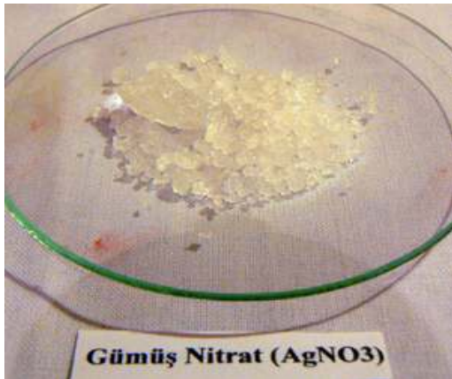
Resim 76: Mineral değerinin pahalı oluşundan dolayı güçlükle elde edilen gümüş nitrat seramik, cam ve ilaç sanayinde bir çok reçetede kullanılmaktadır.
