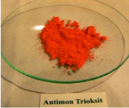
Resim 75: Seramik teknolojisinde sıkça kullanılan bir ergiticidir. Genel görünümü erime ısısı ve kullanım koşulları kurşun oksitle benzerlik gösterir.
