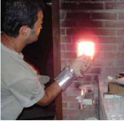
Resim 13: Çıkardığı zehirli gazları sebebiyle özel fırınlarda pişirim gerektiren tuz sırası çalışması
