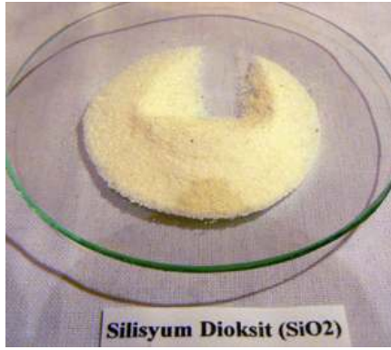
Resim 65: Silisyum Dioksit cam sanayinde ve seramik sırlarında camsılaşmayı sağlayan en temel oksittir.
