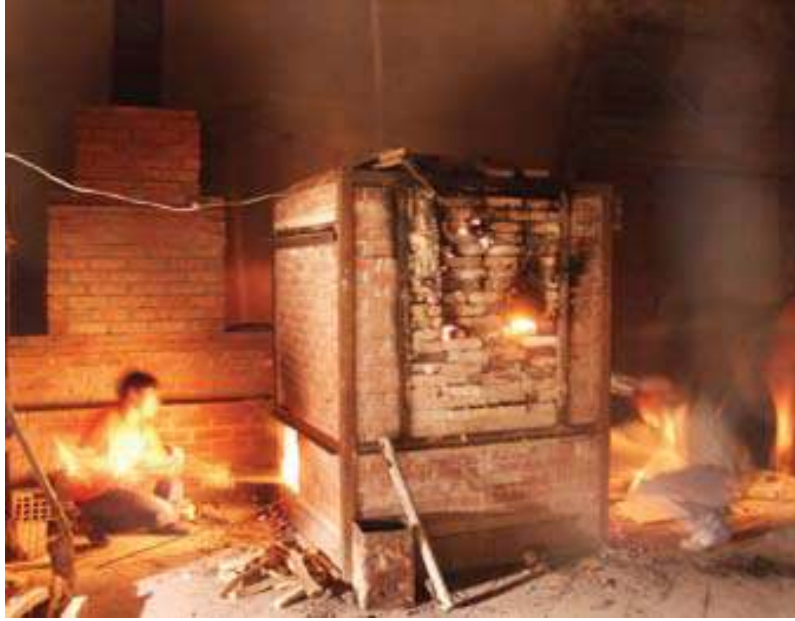
Resim 12: Güçlü bir baca sistemiyle donatılmış ve çok kontrollü müdahale odacıklarıyla desteklenmiş klasik bir tuz fırını örneği
