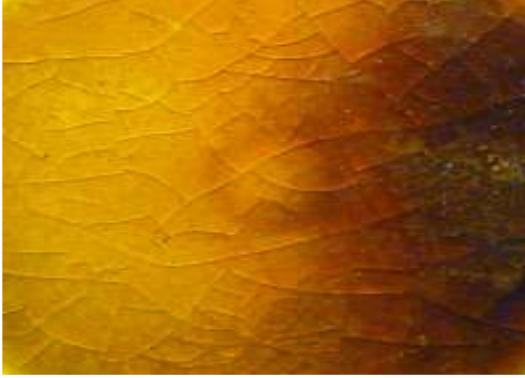
Resim 102: Seger Deneme Numarası (4) 750°C'de Demir Kromatlı Sır Detayı
