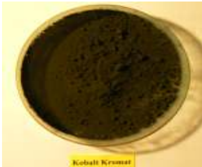
Resim 205: Yüksek saflıkta \text{CoCrO}_4 tozundan bir görünüm
