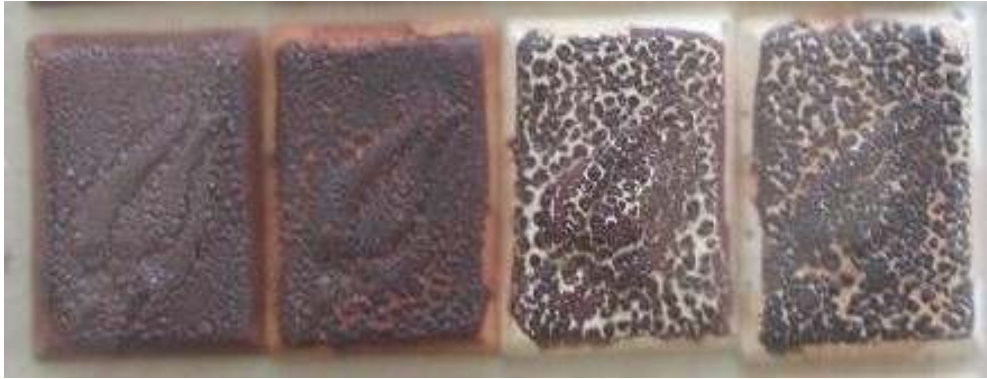
Resim 6: Soldan sağa; Kırmızı Menemen çamuru, Şamotlu çamur, Kütahya çini çamuru ve Söğüt döküm çamuru. 980°C de pişirilmiş toplanmalı sır örnekleri
