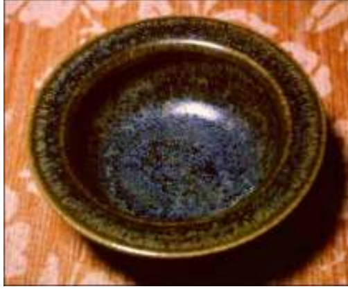
Resim 1: Aventürin sırlarda en bilinen demir oksit efektinin yatay ve dikey yüzeyde oluşturduğu kristal yapıyı gösteren bir çalışma örneği.
