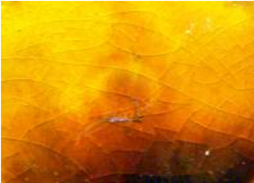
Resim 103: Seger Deneme Numarası (4) 1020°C'de Demir Kromatlı Sır Detayı
